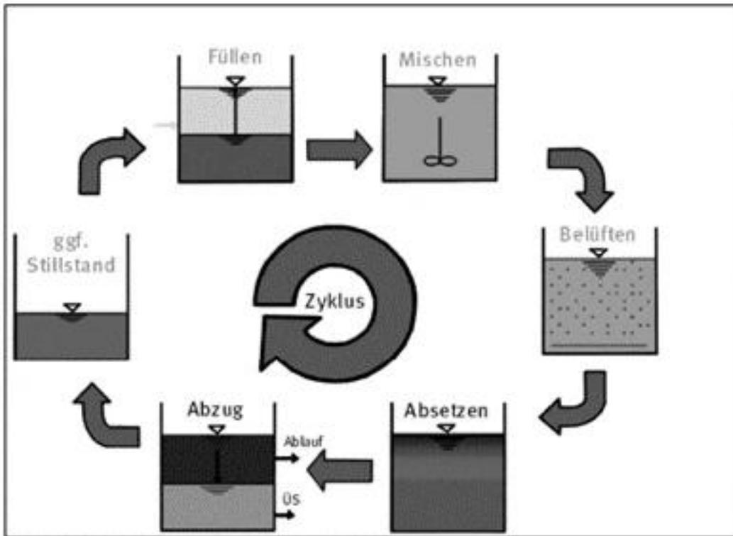
Die Vorteile des SBR-Verfahrens sind der geringerer Platzbedarf als bei einer konventionellen Belebungsanlage, die hohe betriebliche Flexibilität (durch Anpassung der Zykluszeiten an die Zulaufbelastung), die Möglichkeit zur gezielten Denitrifikation sowie die Möglichkeit zur aeroben Schlammstabilisierung. Zudem haben Betriebserfahrungen gezeigt, dass der Wartungs- und Betriebsaufwand einer SBR-Anlage gering ist.
