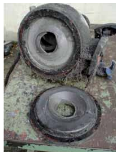
Ablagerungen in Pumpengehäuse
