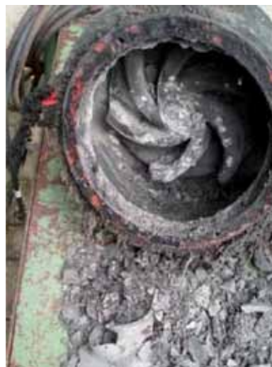
Ablagerungen in Pumpengehäuse
