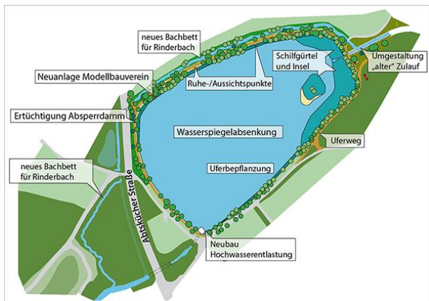
Übersichtskarte Sanierung des Hochwasserrückhaltebeckens Abtskücher Teich, Quelle: BRW
